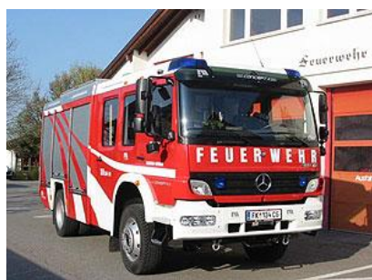
TLF3000/200 (Tanklöschfahrzeug 3000l Wasser/200l Schaum) Fahrzeugwart Hammerle Oliver 2014 gefahrene Kilometer: 489km
